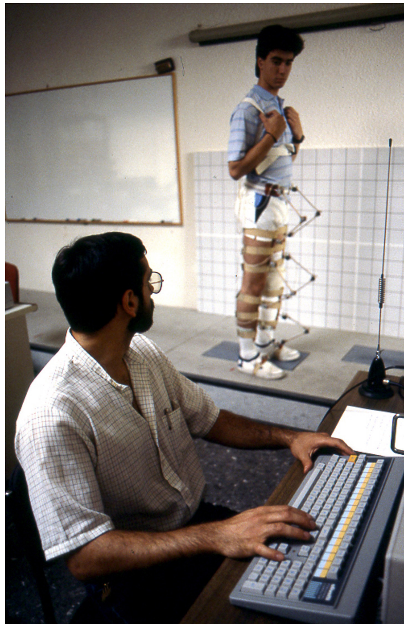
Estudio de la marcha humana de un amputado por debajo de la rodilla mediante electrogoniómetros y plataformas dinamométricas en el marco de las tesis doctorales de Alejandro Cortés y Enrique Viosca.
