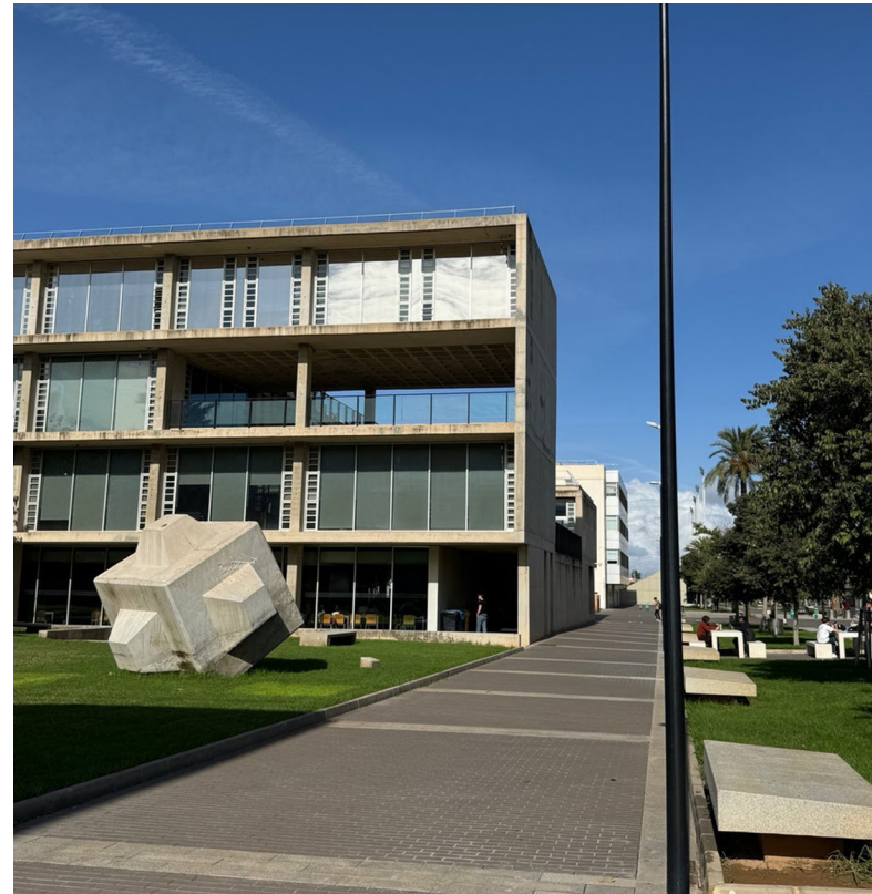
Fachada posterior de la Casa del Alumno , con el cubipod en primer plano, una de las patentes más rentables de la UPV, para la construcción de diques en talud y la protección de márgenes de ríos.
