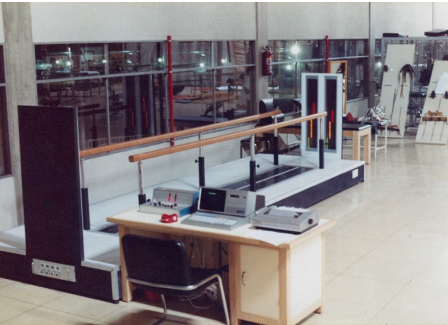
Plataforma para el análisis y rehabilitación de la marcha instalada en la Mutua de Accidentes de Zaragoza en 1982.
